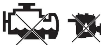
Tanto el motor como el inversor se suministran sin ningún tipo de fluido en su interior. Consulte el manual para seguir el procedimiento de instalación y puesta en marcha, así como la capacidad de fluido por cada sistema - refrigerante, aceite y aceite inversor.
