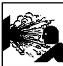
No quite nunca la tapa del refrigerador si el grupo electrógeno está caliente. Saldrán vapor y chorros de refrigerante caliente del motor y pueden quemarle gravemente. Deje que el motor se enfríe antes de intentar quitar la tapa del refrigerador.
