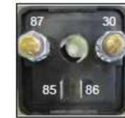
DETALLE RELE DE ARRANQUE / STARTER RELAY
