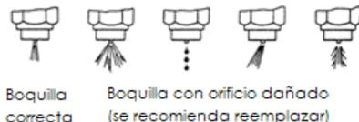
7. Si el inyector es malo, extraiga la punta de ésta y limpie la aguja del inyector y el cuerpo con solución de limpieza. Y si el inyector sigue siendo mala después de lavar la punta, reemplace la punta. Al instalar la nueva punta, extraiga la película de resina sintética de la punta y deslice la aguja del inyector del cuerpo por combustible diésel limpio para limpiar completamente el inhibidor.
