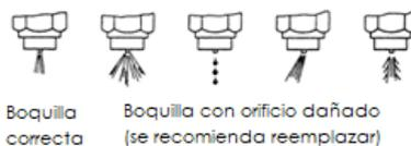
7. Si el inyector es malo, extraiga la punta de ésta y limpie la aguja del inyector y el cuerpo con solución de limpieza. Y si el inyector sigue siendo mala después de lavar la punta, reemplace la punta.
