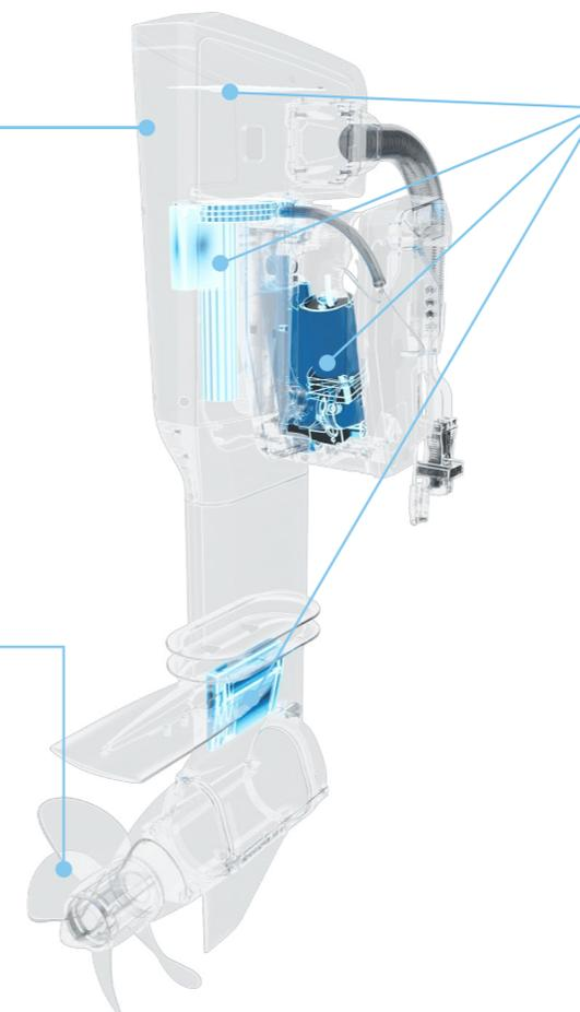
La dirección eléctrica, el trimado/inclinación eléctrica, la ECU (unidad de control eléctrico) y el controlador del motor están integrados en una sola unidad.
